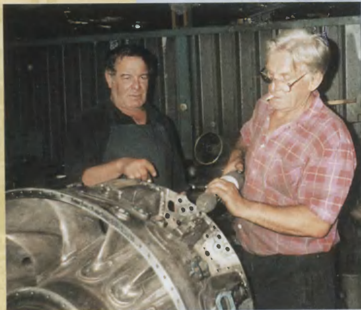
Ветераны цеха №18, слесари-сборщики Е.Н.Авачев и В.М.Соколов готовят к сдаче очередную опору турбины "МВ".
