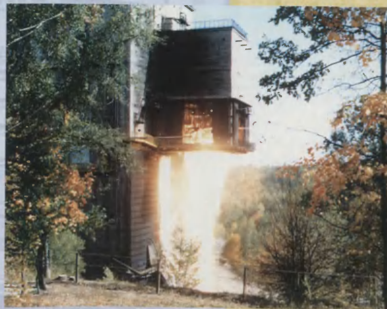
Стендовые испытания двигателя НК-33 после 20-летнего хранения. "Химзавод". 1999 г.
