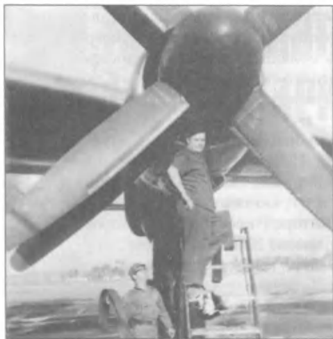
Заводские авиаторы готовили "энергетику" лайнера Ту-114 к первому рейсу через Атлантику – для визита Хрущева в США. В кадре момент, когда начальник участка ЭРО А.М.Носов проверяет состояние компрессорных лопаток на входе в НК-12 МВ... (Фото из личного архива В.Писарева.)
