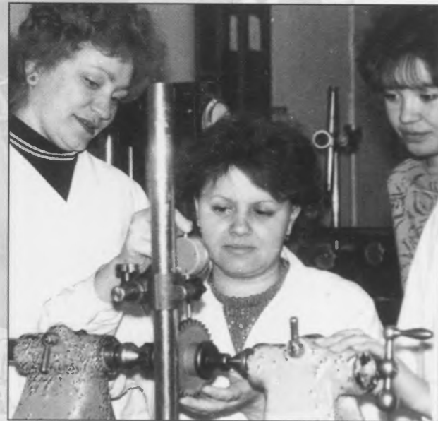
Контролер цеха №12 Л.Зеленина проверяет параметры зубьев шестерни. За ее работой наблюдают контрольный мастер (на фото - слева) и ученица из ОПК.
