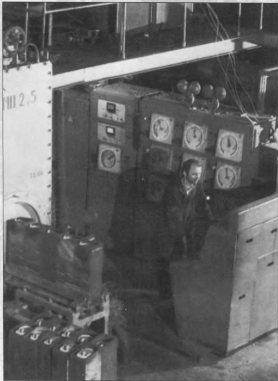
Печь ПМП-2 для литья с направленной кристаллизацией.
